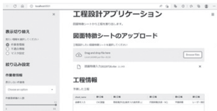
写真3 AI工程設計ソフトの画面。正しい工程順番ごとの加工内容が表示されるほか、作業者の適正配置も表示される
